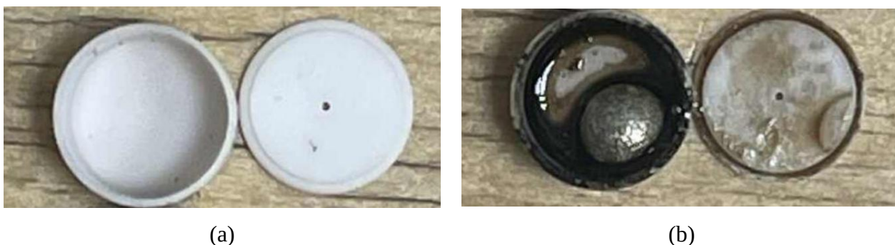
Rys. 3.8. Tygielki z pokrywką korundową: (a) tygielki przed pomiarem , (b) tygielki po wykonanym pomiarze.
